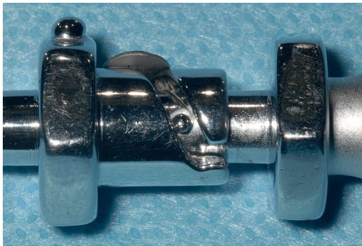
Ryc. 5.4 Mechanizm otwierania i zamykania okna tnącego: uchwyt kaniuli wewnętrznej wchodzi w rowek na kaniuli zewnętrznej.
