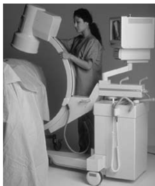
Ryc. 9-10. Aparat przenośny z ramieniem C ustawiany do projekcji PA stawu biodrowego lub jamy brzusznej. Zgoda na publikację: OEC Medical Systems, Inc.
