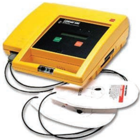
Ryc. 12-8 Automatyczny defibrylator zewnętrzny.
