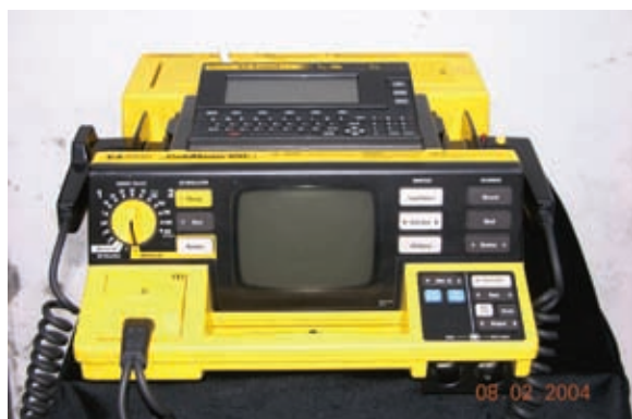
Ryc. 12-9 Defibrylator z funkcją monitora pracy serca umożliwiający prezentację zapisu EKG 12-odprowadzeniowego, przybliżoną interpretację wyników badania, wykonanie kardiowersji, może także pełnić funkcję stymulatora.
