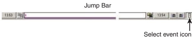
Rycina 2-7 • Wyodrębniony „Jump Bar”. Przedstawia czas trwania klipu, a kliknięcie na pasku przesuwa klip do wskazanego momentu. Pierwsza ikona po prawej, ikona wyboru zdarzenia, włącza lub wyłącza listę adnotacji („Annotation List”).
