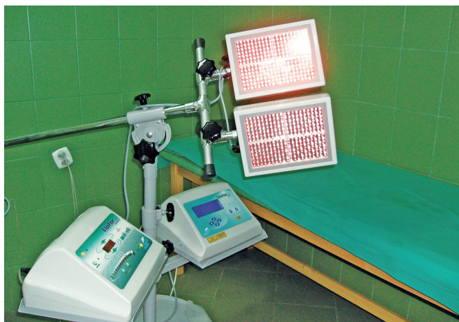
Ryc. 27.3.1. Aparat Viofor JPS Standard z funkcją magnetostymulacji i Viofor Light z funkcją światła diod LED R i IR. Funkcję światła można stosować samodzielnie lub w synergii z polem magnetycznym z zakresu magnetostymulacji. Panele mają 260 diod świetlnych, razem 580 diod z możliwością naświetlania do 2 m 2 skóry
