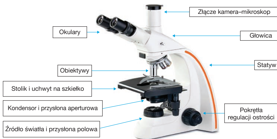
Rycina 1.1. Budowa mikroskopu optycznego.
