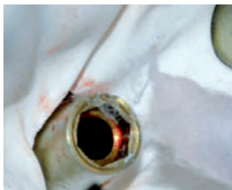
Ryc. 6.28. Oczyszczanie głowicy transferu (zawsze za pomocą zwilżonej watki)
