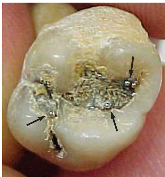
RYCINA 5-7 „Wypocenie” rtęci (strzałki) z wypełnienia amalgamowego, które zostało nieumyślnie poddane autoklawowaniu. Jakkolwiek takie postępowanie nie ma żadnego znaczenia klinicznego, to jednak ilustruje to, że rtęć, która normalnie jest związana chemicznie w obrębie matrycy amalgamatu, może zostać z niej uwolniona przy dostatecznym ogrzaniu. Z tego powodu podczas polerowania lub wymiany amalgamatu należy unikać generowania ciepła. (Zgodna na publikację: K. Frazier, Georgia Health Sciences University, Augusta, Georgia, USA).
